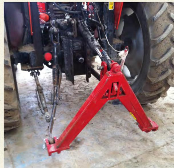
Il est impératif d'avoir un tracteur équipé d'un 3<sup>e</sup> point hydraulique qui permet de faire pivoter le triangle mâle du tracteur. Vous pouvez en monter un sur votre tracteur pour un coût raisonnable (300 € HT).
