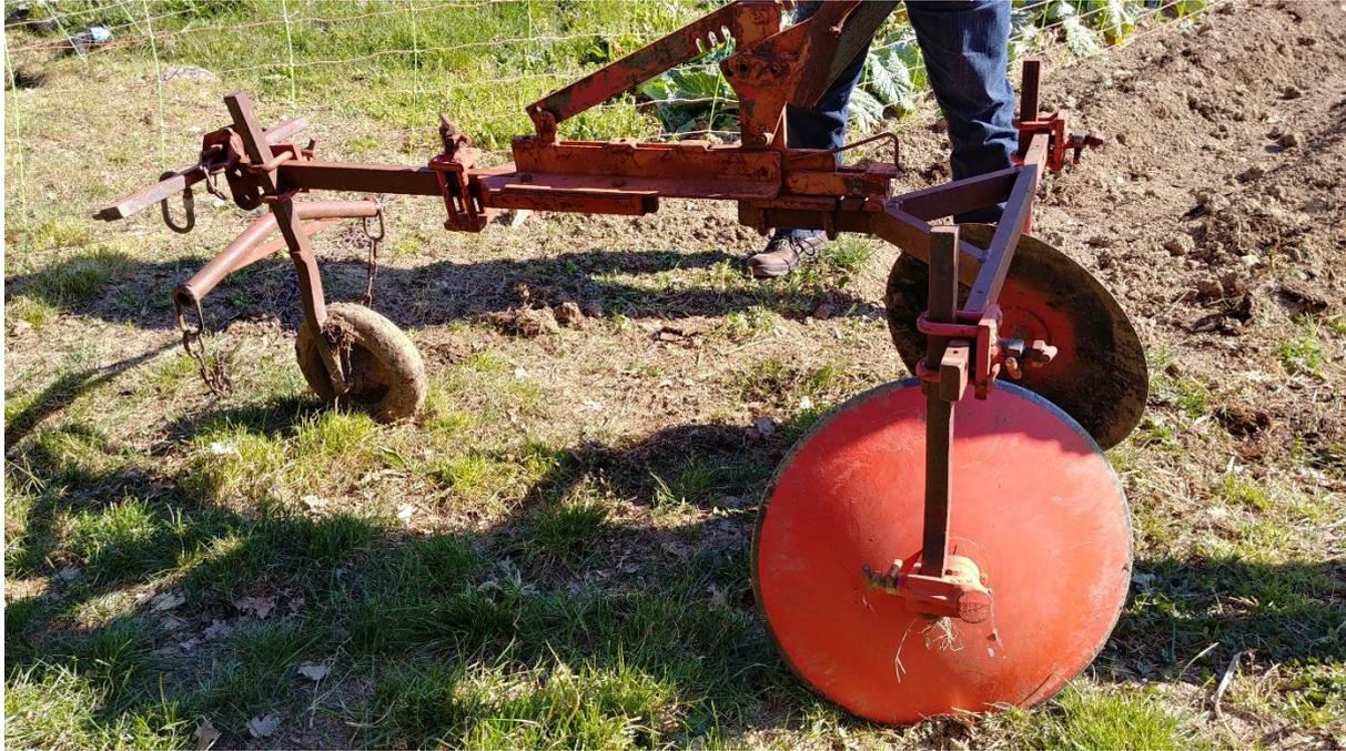
*Figure 6: Kassine sur laquelle sont installés deux disques*
