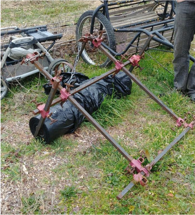
Figure 6: Dériveuse à plastique auto-construite
