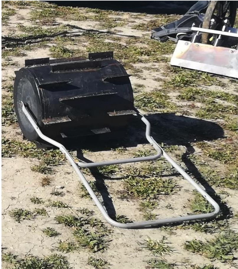
Figure 4 Rouleau faca manuel autoconstruit
